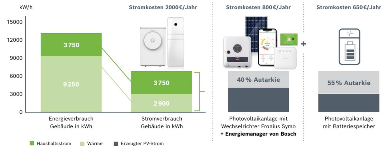
\* Annahme: 50kWh/m²\*a Heizwärmebedarf, PV-Anlage mit 6,2kWp, 5,7kWh Batteriespeicher (90% DoD), Strompreis 0,28€/kWh, Einspeisevergütung: 0,10€/kWh, ohne Berücksichtigung der Investitionskosten und steuerlichen Abschreibungen
